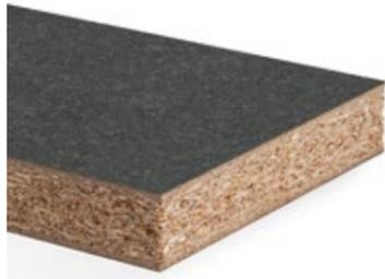
Arbeitsplatte aus einer Holzspanplatte nach EN 312, Dekorseite verklebt mit robustem Duopal XTreme Touch mit einer elektronenstrahlgehärteten Oberfläche in Anlehnung EN 438, Unterseite mit wasserabweisendem Gegenzug. Die Längskanten der Arbeitsplatte sind gefräst. Als Variante ist sie auch einseitig mit einer Schutzkante erhältlich. Duopal XTreme Touch ist ein attraktives Supermatt-Oberflächenmaterial mit Anti-Fingerprint-Effekt in Kombination mit natürlich anmutender Stein- oder Holzstruktur.
