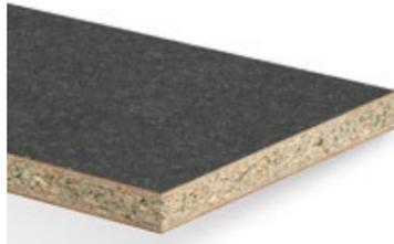
Verbundelement aus einer quellarmen Holzspanplatte Typ P3 nach EN 312 für den Feuchtbereich, beidseitig belegt mit Duopal XTreme Touch, einem attraktiven Supermatt-Oberflächenmaterial mit Anti-Fingerprint-Effekt in Kombination mit natürlich anmutender Stein- oder Holzstruktur.
