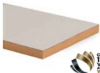
Panneau de fibres de densité moyenne enduit de résine de mélamine recouverte d'une laque multicouche de haute qualité. Cette laque innovante est composée d'une couche fonctionnelle à élasticité permanente et de vernis acryliques durcissant aux UV.
