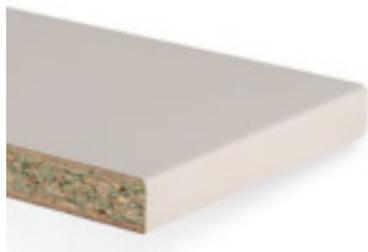
Élément de mobilier composé d'un panneau de particules de bois de type P3 à faible gonflement selon la norme EN 312, replaqué sur les deux faces avec du Duopal stratifié selon la norme EN 438. Le chant longitudinal postformé a un rayon de 3 mm sur la face supérieure et inférieure, ce qui le rend parfaitement adapté comme élément de mobilier, rebord de fenêtre ou plan de travail mince.
