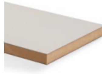
Élément replaqué composé d'un panneau de fibres de densité moyenne (MDF) avec une structure homogène conformément à la norme EN 622-1, recouvert sur les deux faces de Duopal HPL.
