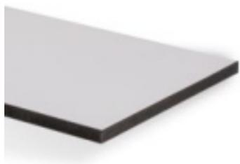
Élément replaqué composé d'un panneau décoratif de fibres de densité moyenne (MDF) avec une structure homogène conformément à la norme EN 622-1, recouvert sur les deux faces de Duropol HPL.
