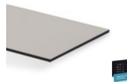
Stratifié haute pression compact pour l'extérieur en qualité standard conformément à la norme EN 438-6:EDS / pour les décors intenses conformément à la norme EN 438-6:EGS. Composé d'un noyau noir homogène, revêtu d'une laque acrylique décorative sur une ou deux faces. Dans le cas d'une seule face laquée, la contreface sera revêtue d'une résine mélaminée décorative.
