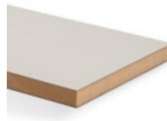
Élément replaqué composé d'un panneau de fibres de densité moyenne (MDF) avec une structure homogène conformément à la norme EN 622-1, recouvert sur les deux faces de Duopal XTreme plus, un matériau de surface supermat avec un effet anti-traces de doigts, idéal pour les surfaces horizontales très sollicitées.
