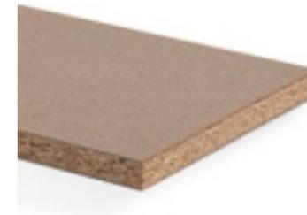
Panneau de particules de bois lié par résine d'urée de type P2 conformément à la norme EN 312, convient aux applications non porteuses dans des conditions sèches.
