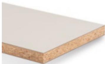
Élément replaqué très résistant avec résistance à la flexion isotrope en panneau de fibres de bois MFP type P5 conformément à la norme EN 312 en tant que couche intermédiaire et, de chaque côté, d'un panneau mince de fibres haute densité (HDF) conformément à la norme EN 622-1, recouvert sur les deux faces de Duropol HPL. La combinaison innovante de matériaux dérivés du bois offre une stabilité maximale et une régularité de surface optimale.
