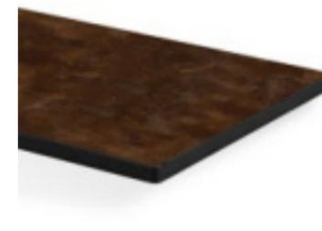
Stratifié haute pression compact avec un ou deux chants longitudinaux usinés, en qualité standard, conformément à la norme EN 438-4:CGS ou EN 438-9:BCS pour une utilisation en tant que plan de travail. Noyau noir, gris ou blanc homogène, surface décorative en résine mélaminée une face et contrebalancement décoratif sur l'autre face.
