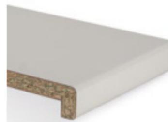
Tablette de fenêtre composée d'un panneau de particules de bois à faible gonflement selon la norme EN 312, recouverte de HPL Duopal robuste conformément à la norme EN 438. Le bord longitudinal postformé présente un rayon de 3 mm et est muni d'une retombée. La retombée de 38 mm apporte une touche visuelle élégante. Les avancées peuvent donc être recouvertes et les revêtements de radiateur peuvent être posés de manière élégante.
