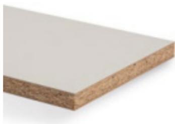
Combinaison d'un panneau de fibres de bois (MFP) en tant que couche intermédiaire et, de chaque côté, d'un panneau mince de fibres haute densité (HDF) en tant que couche de finition avec résine de mélamine décorative sur les deux faces.
