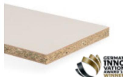
Panneau de particules de bois enduit de résine de mélamine recouverte d'une laque multicouche de haute qualité adapté aux conditions humides. Cette laque innovante est composée d'une couche fonctionnelle à élasticité permanente et de vernis acryliques durcissant aux UV.
