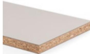
Élément replaqué composé d'un panneau de particules de bois de type P2 conformément à la norme EN 312, recouvert sur les deux faces de Duopal HPL. La très faible teneur en formaldéhyde de ce matériau de panneaux permet de respecter les limites des normes EPF et CARB2.
