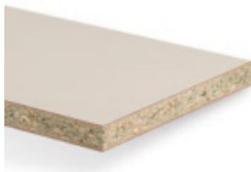
Élément replaqué composé d'un panneau de particules de bois de type P3 à faible gonflement conformément à la norme EN 312 dans des conditions humides, recouvert sur les deux faces de Duopal XTreme plus, un matériau de surface supermat avec un effet anti-traces de doigts, idéal pour les surfaces horizontales très sollicitées.
