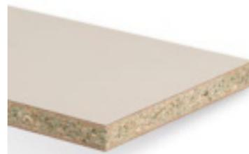
Élément replaqué composé d'un panneau de particules de bois de type P3 à faible gonflement conformément à la norme EN 312 dans des conditions humides, recouvert sur les deux faces de Duopal XTremeun matériau de surface supermat avec un effet anti-traces de doigts.
