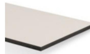
Stratifié haute pression compact de qualité ignifuge conformément à la norme EN 438-4:CGF. Ce stratifié a une âme de couleur noire et deux faces en résine de mélamine décorative.
