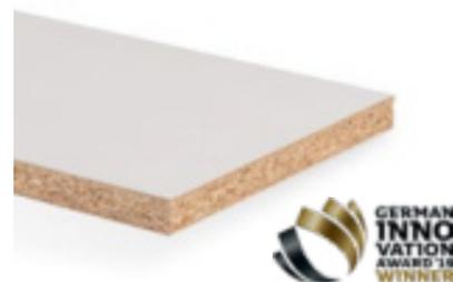
Panneau de particules de bois enduit de résine de mélamine recouverte d'une laque multicouche de haute qualité. Cette laque innovante est composée d'une couche fonctionnelle à élasticité permanente et de vernis acryliques durcissant aux UV.
