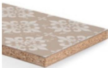
Élément replaqué conçu avec différents modèles d'impression numérique composé d'un panneau de particules de bois de type P2 conformément à la norme EN 312, face supérieure recouverte de Duopal HPL Individual Motiv, face arrière blanche. Notre offre Individual vous permet d'utiliser vos propres images comme motif et est réalisable à partir d'un exemplaire.
