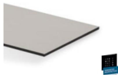
Stratifié haute pression compact pour l'extérieur en qualité ignifuge conformément à la norme EN 438-6:EDF / pour les décors intensifs conformément à la norme EN 438-6:EGF. Composé d'un noyau noir homogène, revêtu d'une laque acrylique décorative sur la face supérieure, la contreface sera revêtue d'une résine mélaminée décorative.
