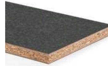
Verbundelement aus einer Holzspanplatte Typ P2 nach EN 312, beidseitig belegt mit Duopal XTreme Touch, einem attraktiven Supermatt-Oberflächenmaterial mit Anti-Fingerprint-Effekt in Kombination mit natürlich anmutender Stein- oder Holzstruktur.
