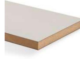
Verbundelement aus einer mitteldichten Faserplatte (MDF) mit homogenem Aufbau nach EN 622-1, beidseitig belegt mit Duopal HPL.
