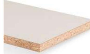
Holzspanplatte Typ P6 gemäß DIN EN 312, hoch belastbar, für tragende Zwecke zur Verwendung im Trockenbereich, beidseitig melaminbeschichtet, schwer entflammbar.
