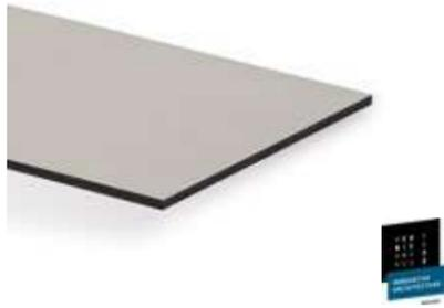
Compact Hochdruckschichtstoff für die Außenanwendung in flammhemmender Qualität gemäß EN 438-6:EDF / Intensiv-Dekore gemäß EN 438-6:EGF. Mit homogen schwarz gefärbtem Kern und einseitiger dekorativer Acryllack-Lackierung auf der Oberseite und rückseitiger dekorativer Melaminharzoberfläche.
