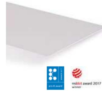
Dekorativer Hochdruckschichtstoff in Standard-Qualität in Anlehnung an EN 438-9:BTS, mit strapazierfähiger, elektronenstrahlgehärteter Oberfläche und durchgehend dekoridentisch gefärbtem Kern für höchste Ansprüche an Ästhetik, Funktionalität und Langlebigkeit. Die Rückseite ist verleimfähig geschliffen. Duopal XTreme ist ein attraktives Supermatt-Oberflächenmaterial mit Anti-Fingerprint-Effekt.
