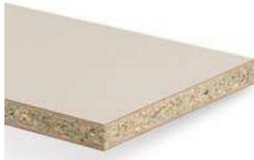
Verbundelement aus einer quellarmen Holzspanplatte Typ P3 nach EN 312 für den Feuchtbereich, beidseitig belegt mit Duopal XTreme, einem attraktiven Supermatt-Oberflächenmaterial mit Anti-Fingerprint-Effekt.
