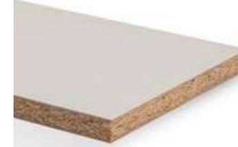
Kombination aus einer Holzspanplatte (MFP) als Mittellage und jeweils einer hochverdichteten dünnen Faserplatte (HDF) als Deckschicht mit beidseitiger dekorativer Melaminbeschichtung.
