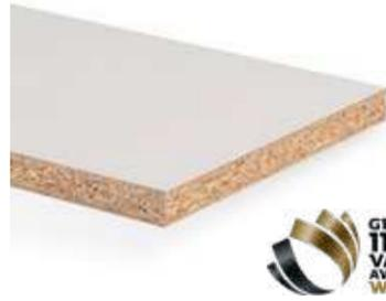
Emissionsminimierte melaminbeschichtete Holzspanplatte mit hochwertiger und innovativer Mehrschicht-Lackierung bestehend aus einer dauerelastischen Funktionsschicht und UV-härtenden Acryllacken.
