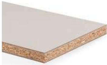
Verbundelement aus einer Holzspanplatte Typ P2 nach EN 312, beidseitig belegt mit Duopal HPL. Mit diesem Plattenwerkstoff werden aufgrund des absolut minimierten Formaldehydgehalts die Grenzwerte des EPF- sowie des CARB2-Standards problemlos eingehalten.
