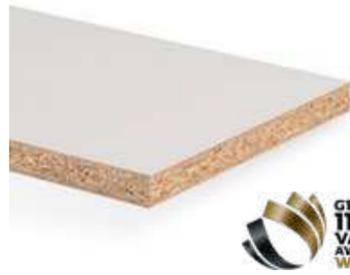
Melaminbeschichtete Holzspanplatte mit hochwertiger und innovativer Mehrschicht-Lackierung bestehend aus einer dauerelastischen Funktionsschicht und UV-härtenden Acryllacken.
