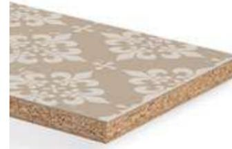
Harnstoffharzgebundene Holzspanplatte mit individuellen Digitaldruck-Motiven im Direktbeschichtungsverfahren, ausgezeichnet mit dem Blauen Engel. Die Vorderseite ist nach Wunsch bedruckt, die Rückseite standardmäßig weiß.
