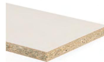
Holzspanplatte Typ P5 gemäß DIN EN 312, für tragende Zwecke zur Verwendung im Feuchtbereich, beidseitig melaminbeschichtet.
