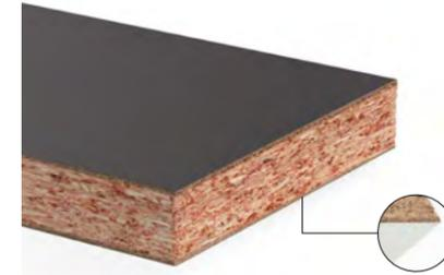
Holzspanplatte Typ P4 gemäß DIN EN 312, für tragende Zwecke zur Verwendung im Trockenbereich, beidseitig melaminbeschichtet, schwer entflammbar.
