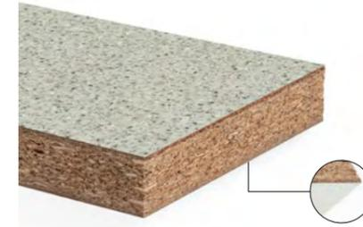
Holzspanplatte Typ P6 gemäß DIN EN 312, hoch belastbar, für tragende Zwecke zur Verwendung im Trockenbereich, beidseitig melaminbeschichtet, schwer entflammbar.
