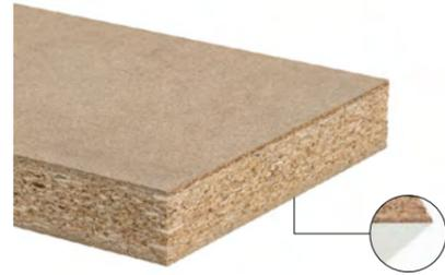
Holzspanplatte Typ P6 gemäß DIN EN 312, hoch belastbar, für tragende Zwecke zur Verwendung im Trockenbereich, einseitig melaminbeschichtet.
