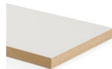
Panneau replaqué stratifié composé d'un panneau de fibres de densité moyenne (MDF) avec une structure homogène, recouvert sur les deux faces de Duopal SolidColor XTreme, un noyau stratifié teinté dans la masse identique au décor et un matériau de surface supermat avec un effet anti-traces de doigts.
