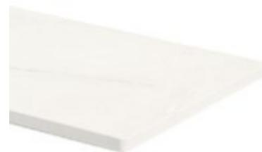
Panneau stratifié compact avec un ou deux chants longitudinaux usinés, en qualité standard conformément à la norme EN 438-9:BCS pour une utilisation en tant que plan de travail. Noyau blanc homogène, surface décorative en résine mélaminée une face et contrebalancement sur l'autre face.
