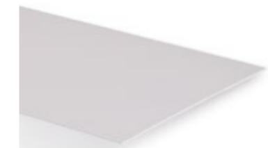
Panneau stratifié décoratif de qualité standard d'après la norme EN 438-9:BTS. Il dispose d'une surface laquée résistante et d'un noyau teinté dans la masse identique au décor. La face arrière est poncée afin d'être prête pour le collage. Duropal SolidColor XTreme est un matériau de surface supermat avec un effet anti-traces de doigts.
