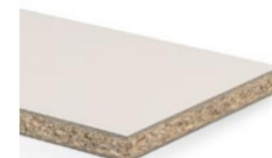
Panneau replaqué stratifié à dissipant l'électrostatique composé d'un panneau de particules ESA de bois de type P2 conformément à la norme EN 312, recouvert sur les deux faces de Duopal HPL ESA.
