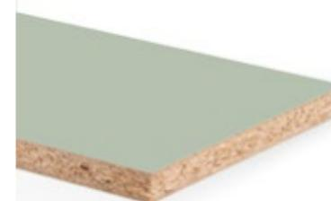
Panneau de particules de bois enduit de résine de mélamine de type P2 conformément à la norme EN 312, avec un encollage 100 % biosourcé et sans formaldéhyde (OrganicGlue), 100 % de bois recyclés post-consommation ainsi qu'une laque supermate de haute qualité et innovante et un effet anti-traces de doigts pour les applications verticales.
