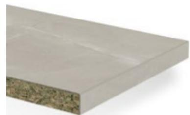
Plan de travail composé d'un panneau de particules de bois à gonflement réduit en épaisseur de type Hydrofuge MR adapté aux conditions humides conformément à la norme EN 312, face décorative recouvert d'un Duropal HPL, face inférieure dotée d'un contrebalancement pare vapeur. Les deux côtés du plan de travail PerForm sont proposés avec chants laser.
