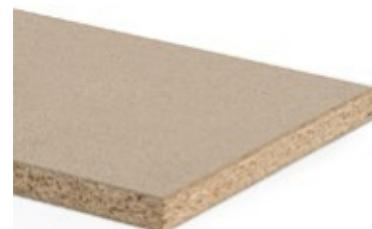
Panneau de particules de bois avec un encollage 50 % biosourcé et sans formaldéhyde (OrganicGlue), fabriqué à partir de 50 % de bois recyclés post-consommation. Panneaux P2 selon la norme EN 312, adaptés aux utilisations non porteuses en milieu sec.
