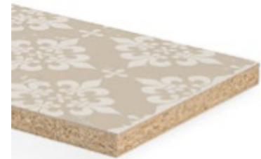
Panneau de particules de bois lié par résine d'urée, conçu avec différents modèles d'impression numérique via un processus de revêtement direct, au label écologique Blue Angel. La face avant est imprimée sur demande, la face arrière est blanche de manière standard.
