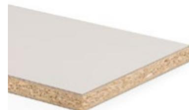
Panneau replaqué stratifié composé d'un panneau de particules de bois de type P2 conformément à la norme EN 312, recouvert sur les deux faces de Duopal XTreme, un matériau de surface supermat avec un effet anti-traces de doigts.
