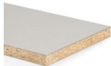
Panneau replaqué stratifié composé d'un panneau de particules de bois de type P2 conformément à la norme EN 312, avec un encollage 100 % biosourcé et sans formaldéhyde (OrganicGlue) et 100 % de bois recyclés post-consommation, recouvert sur les deux faces de Duopal HPL Métal véritable.
