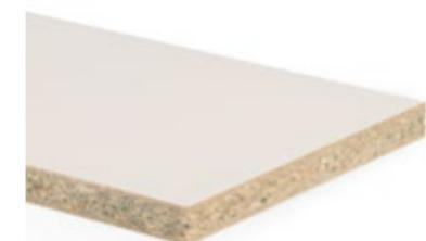
Panneau de particules de bois enduit de résine de mélamine de type P3 pour les zones humides, avec d'une laque multicouche brillante de haute qualité et innovante composée d'une couche fonctionnelle à élasticité permanente pour les applications verticales.
