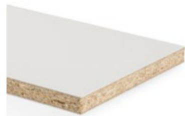
Panneau replaqué stratifié composé d'un panneau de particules de bois de type P2 conformément à la norme EN 312, recouvert sur les deux faces de Duopal SolidColor XTreme, un noyau stratifié teinté dans la masse identique au décor et un matériau de surface supermat avec un effet anti-traces de doigts.
