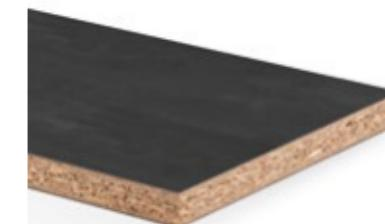
Panneau replaqué stratifié composé d'un panneau de particules de bois de type P2 conformément à la norme EN 312, recouvert sur les deux faces de Duopal XTreme Touch, un matériau de surface supermat avec un effet anti-traces de doigts en combinaison avec une structure de pierre ou de bois d'aspect naturel.
