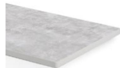
Panneau stratifié compact avec un ou deux chants longitudinaux usinés, en qualité standard conformément à la norme EN 438-9:BCS pour une utilisation en tant que plan de travail. Noyau gris homogène, surface décorative en résine mélaminée une face et contrebalancement sur l'autre face.
