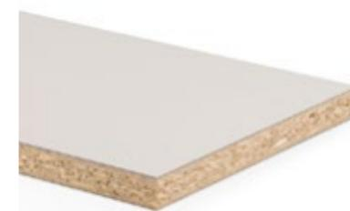
Panneau replaqué stratifié composé d'un panneau de particules de bois de type P2 conformément à la norme EN 312, recouvert sur les deux faces de Duopal HPL XTreme plus, un matériau de surface supermat avec un effet anti-traces de doigts, idéal pour les surfaces horizontales fortement sollicitées.
