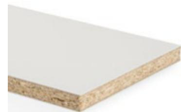
Panneau replaqué stratifié composé d'un panneau de particules de bois de type P2 conformément à la norme EN 312, recouvert sur les deux faces de Duropal SolidColor, un noyau stratifié teinté dans la masse identique au décor.
