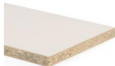
Panneau de particules de bois enduit de résine de mélamine de type P3 pour les zones humides, avec une laque supermate de haute qualité et innovante avec un effet anti-traces de doigts pour les applications verticales.
