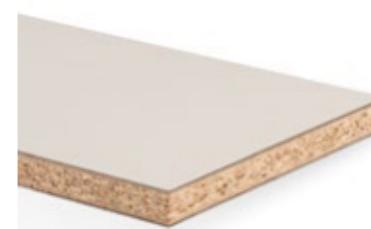
Panneau replaqué stratifié composé d'un panneau de particules de bois de type P2 conformément à la norme EN 312, recouvert sur les deux faces de Duopal HPL Magnétique.
