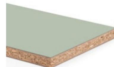
Panneau replqué stratifié composé d'un panneau de particules de bois de type P2 conformément à la norme EN 312, avec un encollage 100 % bio-sourcé et sans formaldéhyde (OrganicGlue) et 100 % de bois recyclés post-consommation, recouvert sur les deux faces de Duopal HPL.
