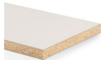
Panneau replaqué stratifié très résistant avec résistance à la flexion isotrope en panneau de fibres de bois MFP conformément à la norme EN 312 en tant que couche intermédiaire et, de chaque côté, d'un panneau mince de fibres haute densité (HDF), recouvert sur les deux faces de Duropal HPL. La combinaison innovante de matériaux dérivés du bois offre une stabilité maximale et une régularité de surface optimale.
