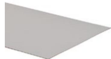
Panneau stratifié décoratif de qualité standard d'après la norme EN 438-3:HGS/VGS. Il dispose d'une surface laquée résistante et d'une face arrière poncée. Duropal HPL XTreme plus est un matériau de surface supermat avec un effet anti-traces de doigts. Il est idéal pour les applications horizontales fortement sollicitées.
