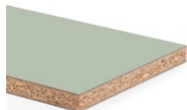
Panneau replqué stratifié composé d'un panneau de particules de bois de type P2 conformément à la norme EN 312, avec un encollage 100 % bio-sourcé et sans formaldéhyde (OrganicGlue) et 100 % de bois recyclés post-consommation, recouvert sur les deux faces de Duopal XTreme, un matériau de surface supermat avec un effet anti-traces de doigts.
