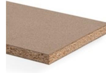
Harnstoffharzgebundene Holzspanplatte Typ P2 gemäß EN 312, geeignet für nicht tragende Zwecke im Trockenbereich.
