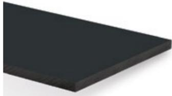
Compact-Hochdruckschichtstoff in Standard-Qualität in Anlehnung an EN 438-4:CGS bzw. EN 438-9:BCS. Mit homogen schwarz, grau oder weiß gefärbtem Kern und beidseitig strapazierfähiger, elektronenstrahlgehärteter Oberfläche. Duropal Compact XTreme plus ist ein attraktives Supermatt-Compactmaterial mit Anti-Fingerprint-Effekt, welches ideal für horizontal, stark beanspruchte Flächen geeignet ist.
