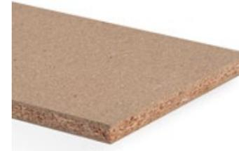
Panneau de particules de bois de type P6 selon la norme EN 312, à haute capacité de charge, pour des applications porteuses dans des conditions sèches, difficilement inflammable.
