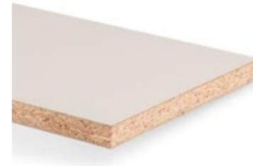
Panneau de particules de bois de type P6 selon la norme EN 312, à haute capacité de charge, pour des applications porteuses dans des conditions sèches, revêtu de décors mélamines des deux côtés, difficilement inflammable.
