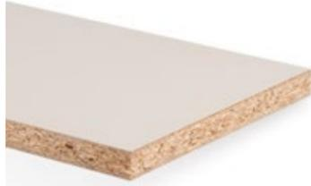
Panneau de particules de bois de type P6 selon la norme EN 312, à haute capacité de charge, pour des applications porteuses dans des conditions sèches, revêtu de décors mélamines des deux côtés.
