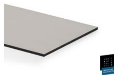
Panneau stratifié compact pour l'extérieur en qualité ignifuge conformément à la norme EN 438-6:EDF / pour les décors intensifs conformément à la norme EN 438-6:EGF. Composé d'un noyau noir homogène, revêtu d'une laque acrylique décorative sur la face supérieure, la contreface sera revêtue d'une résine mélaminée décorative.
