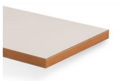
Panneau replaqué stratifié difficilement inflammable composé d'un panneau de fibres de densité moyenne (MDF) avec une structure homogène conformément à la norme EN 622-1, recouvert sur les deux faces de Duopal HPL Pyroex.
