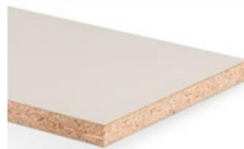
Panneau de particules de bois de type P6 selon la norme EN 312, à haute capacité de charge, pour des applications porteuses dans des conditions sèches, revêtu de décors mélaminés des deux côtés, difficilement inflammable.
