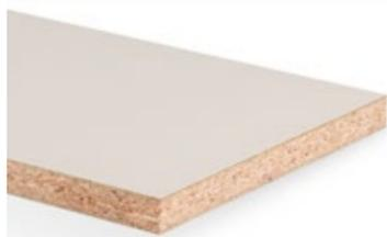
Panneau de particules de bois de type P4 selon la norme EN 312, pour des applications porteuses dans des conditions sèches, revêtu de décors mélaminés des deux côtés, difficilement inflammable.
