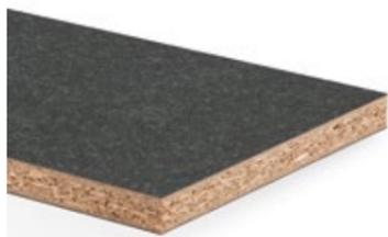
Panneau replaqué stratifié composé d'un panneau de particules de bois de type P2 conformément à la norme EN 312, recouvert sur les deux faces de Duopal XTreme Touch, un matériau de surface supermat avec un effet anti-traces de doigts en combinaison avec une structure de pierre ou de bois d'aspect naturel.
