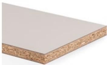
Panneau replaqué stratifié composé d'un panneau de particules de bois de type P2 conformément à la norme EN 312, recouvert sur les deux faces de Duopal HPL.
