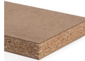
Holzspanplatte Typ P6 gemäß EN 312, hoch belastbar, für tragende Zwecke zur Verwendung im Trockenbereich.
