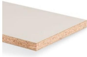
Holzspanplatte Typ P4 gemäß DIN EN 312, für tragende Zwecke zur Verwendung im Trockenbereich, beidseitig melaminbeschichtet, schwer entflammbar.
