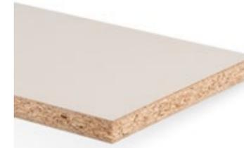
Holzspanplatte Typ P4 gemäß DIN EN 312, für tragende Zwecke zur Verwendung im Trockenbereich, beidseitig melaminbeschichtet.
