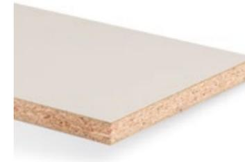
Holzspanplatte Typ P6 gemäß DIN EN 312, hoch belastbar, für tragende Zwecke zur Verwendung im Trockenbereich, beidseitig melaminbeschichtet, schwer entflammbar.
