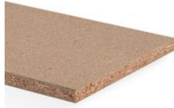
Holzspanplatte Typ P4 gemäß DIN EN 312, für tragende Zwecke zur Verwendung im Trockenbereich, schwer entflammbar.
