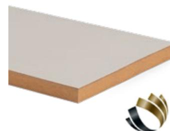
Panneau de fibres de densité moyenne enduit de résine de mélamine recouverte d'une laque multicouche de haute qualité. Cette laque innovante est composée d'une couche fonctionnelle à élasticité permanente et de vernis acryliques durcissant aux UV.
