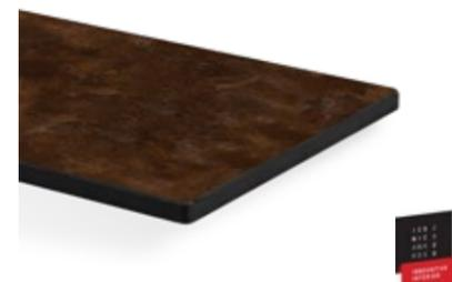
Panneau stratifié compact avec un ou deux chants longitudinaux usinés, en qualité standard, conformément à la norme EN 438-4:CGS ou EN 438-9:BCS pour une utilisation en tant que plan de travail. Noyau noir, gris ou blanc homogène, surface décorative en résine mélaminée une face et contrebalancement décoratif sur l'autre face.
