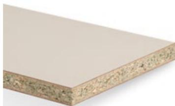
Panneau replaqué stratifié composé d'un panneau de particules de bois de type P3 à faible gonflement conformément à la norme EN 312 dans des conditions humides, recouvert sur les deux faces de Duopal HPL.
