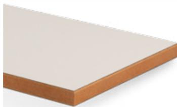
Panneau replaqué stratifié difficilement inflammable composé d'un panneau de fibres de densité moyenne (MDF) avec une structure homogène conformément à la norme EN 622-1, recouvert sur les deux faces de Duropal HPL Pyroex.
