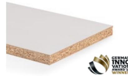
Melaminbeschichtete Holzspanplatte mit hochwertiger und innovativer Mehrschicht-Lackierung, bestehend aus einer dauerelastischen Funktionsschicht und UV-härtenden Acryllacken.
