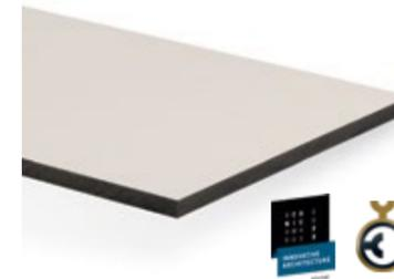
Compact-Hochdruckschichtstoff in Standard-Qualität in Anlehnung an EN 438-4:CGS bzw. EN 438-9:BCS. Mit homogen schwarz, grau oder weiß ge- färbtem Kern und beidseitig strapazierfähiger, elektronenstrahlgehärteter Oberfläche. Duropal Compact XTreme plus ist ein attraktives Supermatt- Compactmaterial mit Anti-Fingerprint-Effekt, welches ideal für horizontale, stark beanspruchte Flächen geeignet ist.
