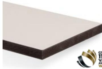
Dekorativ schwarz durchgefärbte mitteldichte Faserplatte mit hochwertiger und innovativer Mehrschicht-Lackierung, bestehend aus einer dauerelastischen Funktionsschicht und UV-härtenden Acryllacken.
