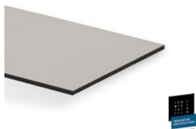
Pannello stratificato ignifugo per utilizzo all' esterno. Qualità come da norma EN 438-6:EDF / tinte unite intense come da norma EN 438-6:EGF. Con kraft omogeneo di colore nero e laccatura acrilica sul lato superiore. Retro con superficie decorativa melamminica.
