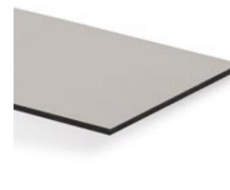
Panneau stratifié compact pour l'extérieur en qualité standard conformément à la norme EN 438-6:EDS / pour les décors intensifs conformément à la norme EN 438-6:EGS. Composé d'un noyau noir homogène, revêtu d'une laque acrylique décorative sur une ou deux faces. Dans le cas d'une seule face laquée, la contreface sera revêtue d'une résine mélaminée décorative.
