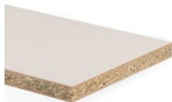
Panneau de particules de bois de type P7 selon la norme EN 312, à haute capacité de charge, pour des applications porteuses dans des conditions humides, revêtu de décors mélaminés des deux côtés.
