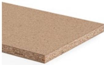
Panneau de particules de bois de type P7 selon la norme EN 312, à haute capacité de charge, pour des applications porteuses dans des conditions humides, non revêtu et 100 % encollé sans formaldéhyde.
