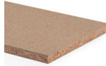
Holzspanplatte Typ P6 gemäß DIN EN 312, hoch belastbar, für tragende Zwecke zur Verwendung im Trockenbereich, schwer entflammbar.
