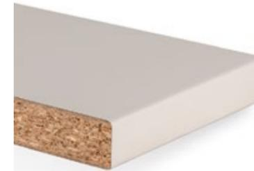
Arbeitsplatte aus einer Holzspanplatte nach EN 312, Dekorseite verklebt mit robustem Duropal HPL nach EN 438, Unterseite mit wasserabweisendem Gegenzug. Die Postforming-Vorderkante der Arbeitsplatte Quadra besitzt einen Radius von 3 mm, die Hinterkante ist mit einer Schutzkante versiegelt. Als Variante ist sie auch beidseitig profiliert erhältlich.
