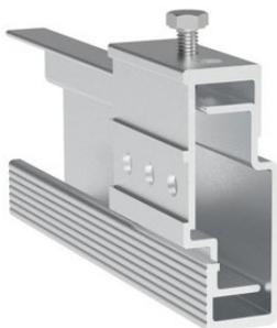
Les profilés porteurs SFS horizontaux se fixent sur les profilés verticaux. Les agrafes fixées sur la face arrière du panneau sont ensuite accrochées dans les profilés porteurs, ajustées et accrochées aux profilés porteurs par un point fixe.
